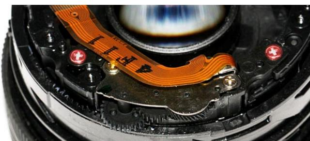
Le bloc moteur STM est tenu par les deux vis P1.3 lg4 teintées en rouge, les deux autres vis visibles sur la photo ne sont pas à déposer et permettent l'ouverture de ce bloc.
