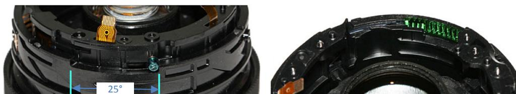
Un codeur constitué d'un peigne conducteur mobile solidaire de la rampe frottant sur un circuit imprimé permet d'informer grossièrement la carte CPU de la distance de mise au point déterminée par la position de la rampe. Seule la position infini (bloc optique rentré) dispose d'une valeur relativement précise ajustée par un réglage lors du montage du peigne. La résolution totale de ce codeur est de 14 valeurs.
